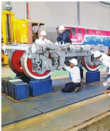
နေပြည်တော်စက်ခေါင်းသစ်တပ်ဆင်ထုတ်လုပ်ရေးစက်ရုံမှ မြင်းကောင်ရေ ၁၂၀၀ ဒီဇယ်လျှပ်စစ်စက်ခေါင်းသစ် သုံးခေါင်းတည်ဆောက်ထုတ်လုပ်နေမှုမှတ်တမ်း။
