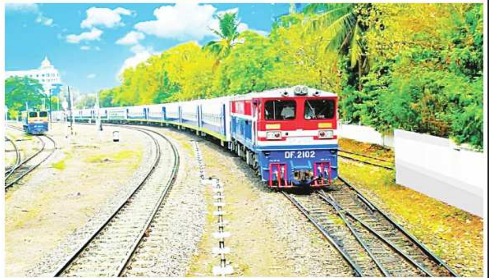
ဒီဇယ်စက်ခေါင်း(မြင်းကောင်ရေ ၂၀၀၀)အားအသုံးပြု၍ လူစီးရထားပြေးဆွဲပို့ဆောင်နေမှုမှတ်တမ်း။
