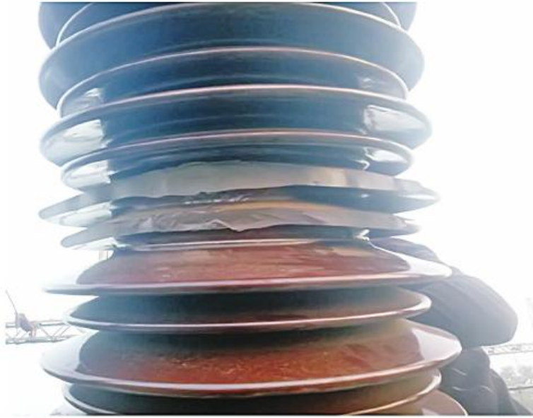
50 MVA ကြေးသီးရစ်လုံးပျက်စီးမှုမှတ်တမ်းဓာတ်ပုံ။
